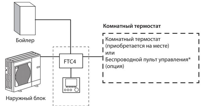
\* Беспроводной пульт управления может быть заменен на комнатный термостат.
