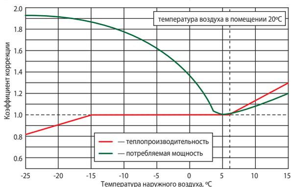
Гарантированная производителем минимальная температура наружного воздуха составляет  $-25^{\circ}\text{C}$ .
