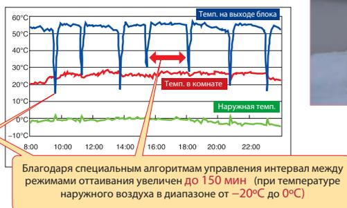
Пример эксплуатации наружного блока
