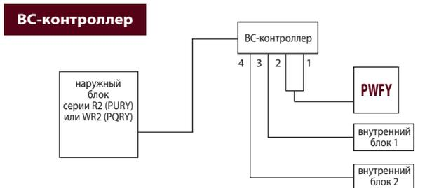
Существуют модификации ВС-контроллеров с разным количеством портов (штуцеров для подключения внутренних блоков). Выбор модификации осуществляется, исходя из количества помещений, в которых нужно обеспечивать охлаждение и обогрев независимо. Также следует принимать во внимание суммарную производительность внутренних блоков.
