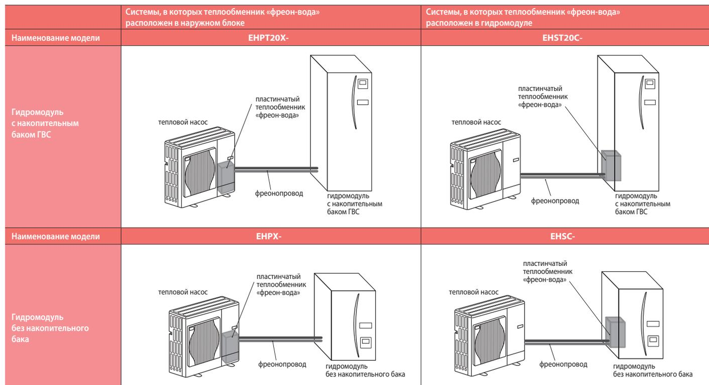
Гидро модули с накопительным баком ГВС и встроенным теплообменником «фреон-вода»
