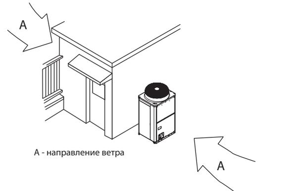
б) Выбирая место для установки наружного блока, расположите его так, чтобы ветер преимущественного направления не воздействовал на теплообменник. Расположите блок передней панелью к направлению ветра.
