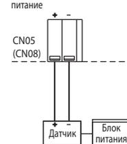
(б) блок питания подключается в линию датчика 4-20 мА пост. тока
