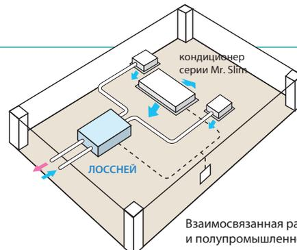
Взаимосвязанная работа вентустановки ЛОССНЕЙ и полупромышленного кондиционера
