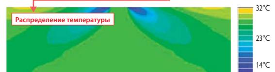
Система учитывает температуру воздуха у пола, поэтому ощущаемая температура стабильно держится на уровне 28°C. Кроме того для создания такого эффекта мощность охлаждения уменьшается через определенное время. Это приводит к существенной экономии электроэнергии.
