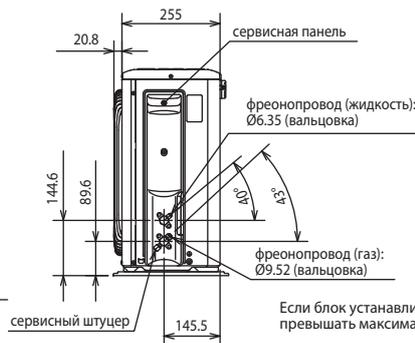
Если блок устанавливается на раме, то ее высота должна в 2 раза превышать максимальную высоту снежного покрова.
