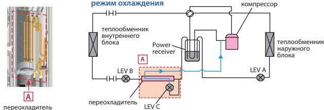
Переохладитель добавлен в гидравлический контур для увеличения энергоэффективности системы в режиме охлаждения. Часть жидкого хладагента испаряется в переохладителе и поступает на вход компрессора, увеличивая давление в линии всасывания. Нагрузка компрессора уменьшается, а энергоэффективность системы увеличивается.
