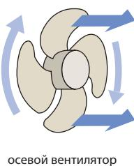
Осевые вентиляторы имеют низкое статическое давление, и их способность удалять воздух из герметизированных помещений ограничена. Также они не могут быть использованы для работы с сетью воздуховодов и дополнительных вентиляционных элементов.
