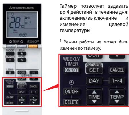
Таймер позволяет задавать до 4 действий<sup>1</sup> в течение дня: включение/выключение и изменение целевой температуры.
