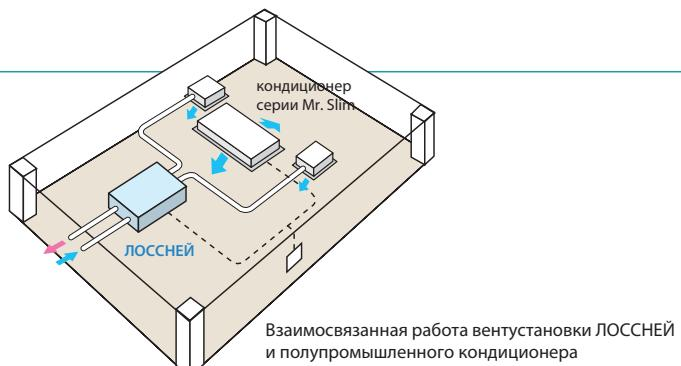
Взаимосвязанная работа вентустановки ЛОССНЕЙ и полупромышленного кондиционера
