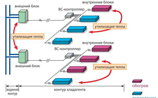
Системы серии WR2 имеют два дополнительных преимущества относительно серии WY. Первое – это полная независимость пользователей и возможность одновременной работы внутренних блоков в режимах охлаждения и обогрева. Второе – максимальная эффективность за счет двух контуров утилизации тепла: контура хладагента в рамках каждой системы и контура теплоносителя, объединяющего несколько систем.
