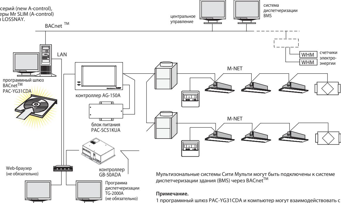
Мультизональные системы Сити Мульти могут быть подключены к системе диспетчеризации здания (BMS) через BACnet™
