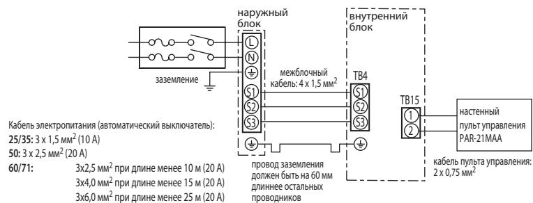
Кабель электропитания (автоматический выключатель):
