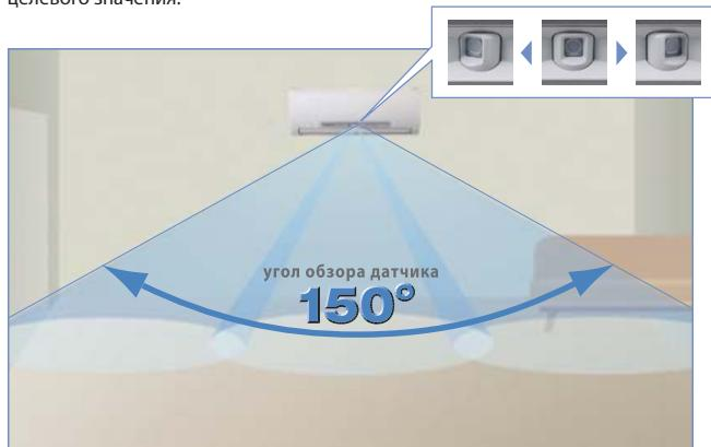
Обычно кондиционеры измеряют температуру воздуха на входе во внутренний блок, который часто располагают достаточно высоко. В результате температура в нижней зоне помещения не всегда оказывается комфортной. Датчик I SEE дистанционно измеряет температуру в нижней зоне, что особенно удобно, например, в детской комнате.
