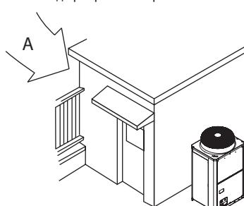
б) Выбирайте место для установки наружного блока, расположите его так, чтобы ветер преимущественного направления не воздействовал на теплообменник. Расположите блок передней панелью к направлению ветра.
