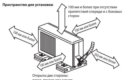
Если блок устанавливается на раме, то ее высота должна в 2 раза превышать максимальную высоту снежного покрова.
