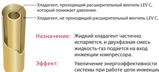
**Назначение:** Жидкий хладагент частично испаряется, и двухфазная смесь жидкость-газ подается на вход инжекции компрессора.
