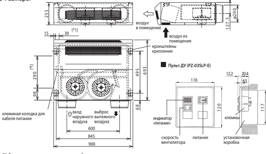
\*1: Расположение отверстия для ввода кабеля электропитания
