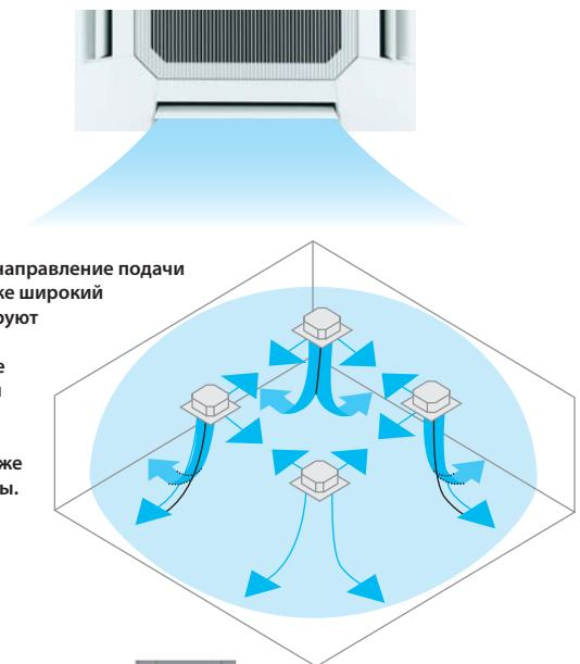
Оптимальное направление подачи воздуха, а также широкий поток гарантируют равномерное распределение температуры и подвижности воздуха в помещении даже в сложной форме.
