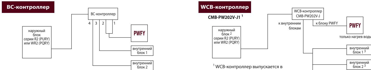
Существуют модификации BC-контроллеров с разным количеством портов (штуцеров для подключения внутренних блоков). Выбор модификации осуществляется, исходя из количества помещений, в которых нужно обеспечивать охлаждение и обогрев независимо. Также следует принимать во внимание суммарную производительность внутренних блоков.
