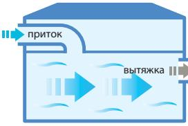
Организация циркуляции воздуха с помощью приточно-вытяжной системы обеспечивает сбалансированный воздухообмен в помещении и эффективное удаление загрязненного воздуха.
