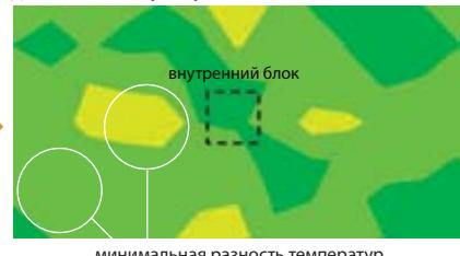
На термографической схеме слева показано распределение температуры в помещении на высоте 1,2 м от уровня пола. Измерения сделаны через 20 минут после включения. Модель внутреннего блока — PLA-RP71BA.
