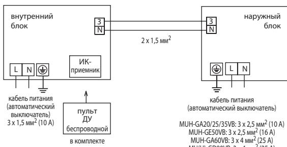
Примечание: кабели электропитания внутреннего и наружного блоков должны быть подключены к одной (общей) фазе!
