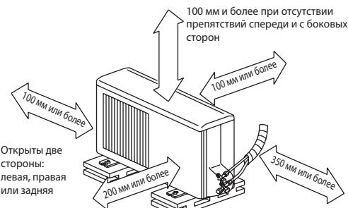
Если блок устанавливается на раме, то ее высота должна в 2 раза превышать максимальную высоту снежного покрова.
