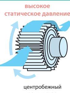
Центробежные вентиляторы характеризуются высоким статическим давлением. Они хорошо удаляют воздух даже из герметизированных помещений. Напор вентилятора достаточен для организации воздухораспределения через сеть воздуховодов.
