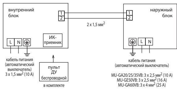
Примечание: кабели электропитания внутреннего и наружного блоков должны быть подключены к одной (общей) фазе!
