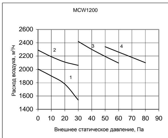
\* Графики характеристик вентиляторов построены для блоков базовой комплектации, т.е. без коробов и фильтров (при высокой скорости вращения вентилятора).
