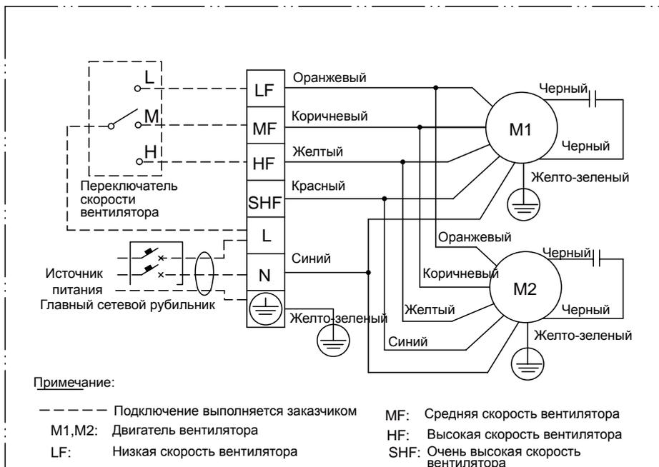
Напор 60Па: LF - низкая скорость, MF - средняя скорость, HF - высокая скорость
