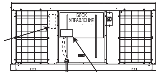
Кабель питания Клеммная колодка
