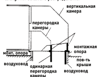
Подсоединение воздуховода с вертикальной воздушной камерой к блоку MRT бокового распределения
