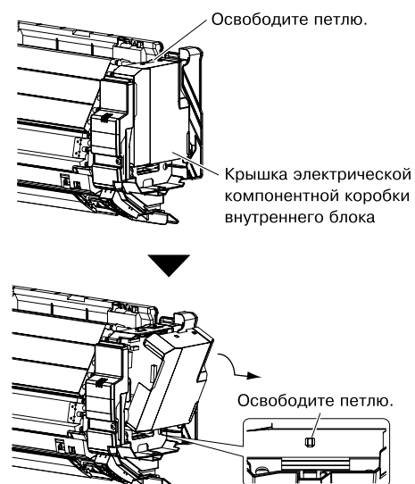
Рисунок 1: Снимите крышку с электрической компонентной коробки внутреннего блока
