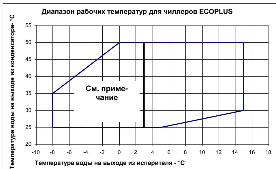
Примечание: использование гликоля необходимо при температуре воды на выходе из испарителя ниже +3°C.
