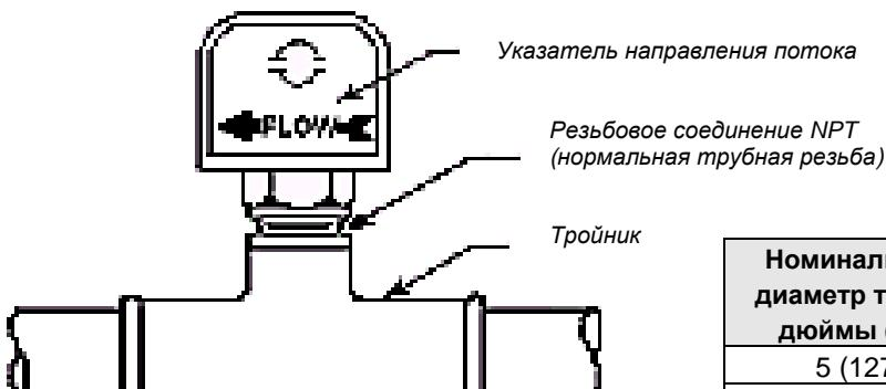
Рис. 4 – Реле протока
