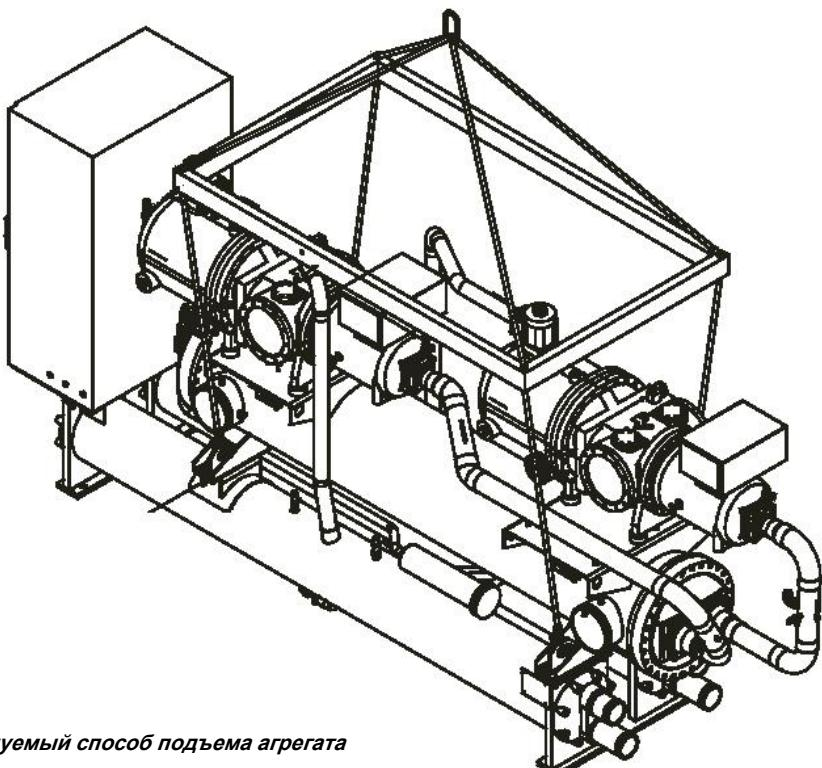
*Рис. 1: Рекомендуемый способ подъема агрегата*
