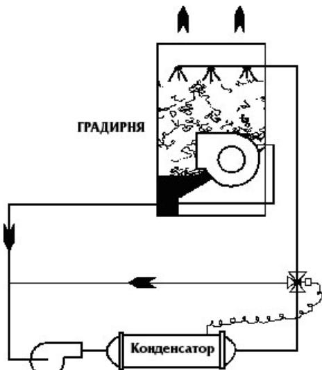
**Рис. 3. Регулирование расхода воды при подаче воды в конденсатор из водопровода или артезианской скважины**
