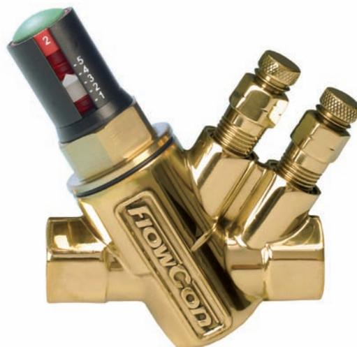
Клапаны FlowCon предназначены для поддержания расхода на заданном уровне при колебаниях давления в системах отопления, кондиционирования, а также любых технологических системах, требующих поддержания постоянного расхода теплоносителя при возможных изменениях давления на контролируемом участке.
