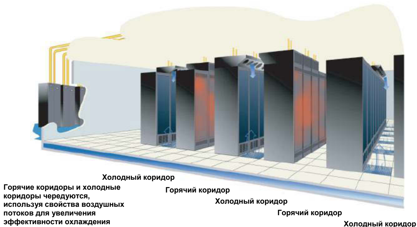
Рисунок 6 Модули Liebert XDV с гибкими трубами с верхней установкой и в компоновке с холодным-горячим коридорами
