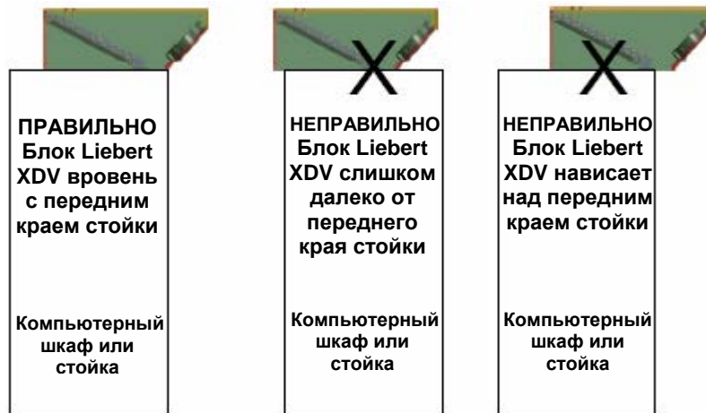
Рисунок 10 Размещение блока Liebert XDV
