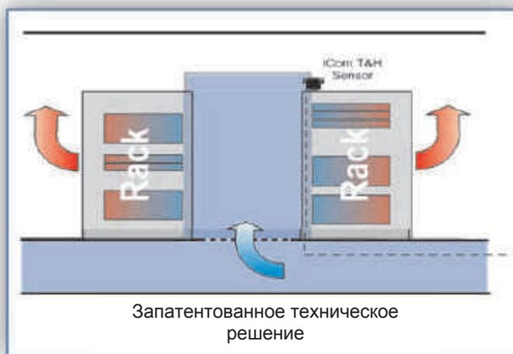
Управление компрессором в блоке осуществляется, исходя из температуры подаваемого воздуха, в то время как расход воздуха будет определяться в соответствии с запатентованным методом управления, на основе значений, поступающих от удаленных датчиков температуры и влажности, установленных в калиброванных отверстиях ограждения Smart Aisle™.
