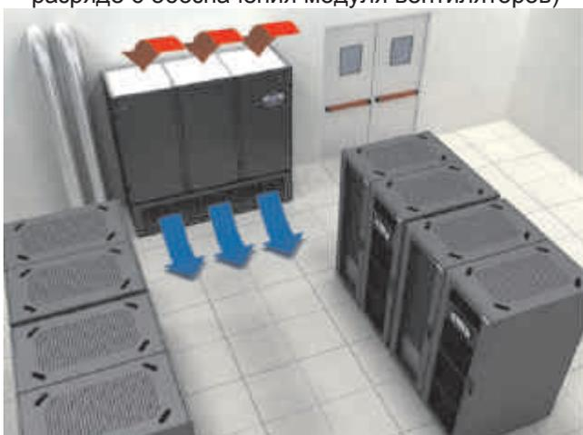
Обратное нагнетание воздуха\* (вариант B в разряде 6 обозначения модуля вентиляторов)
