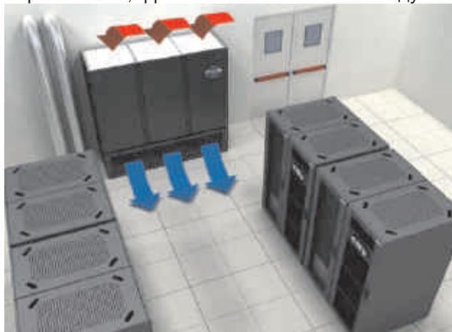
**D - Downflow Up** – с нисходящим потоком воздуха и нижним расположением блока вентиляторов над уровнем фальшпола, нагнетание воздуха вниз
