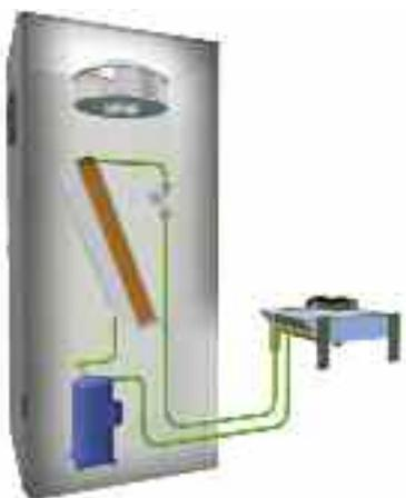
**A** – С воздушным охлаждением с удаленным конденсатором
