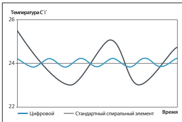
Fig. 5 Сравнение по управлению температурой в комнате между стандартным спиральным блоком и Цифровым блоком
