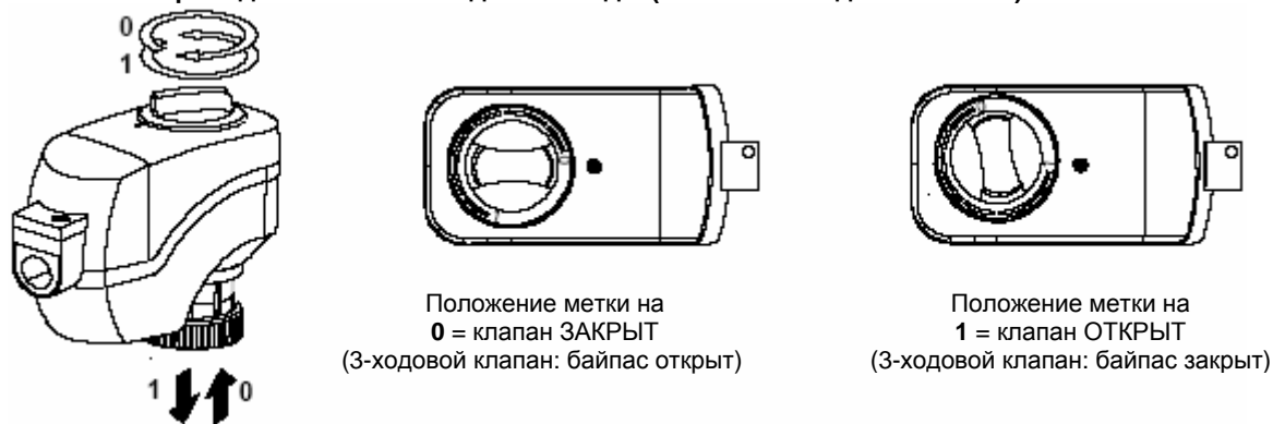
Рис. k – Состояние привода клапана охлажденной воды (2-х или 3-х ходовой клапан).
