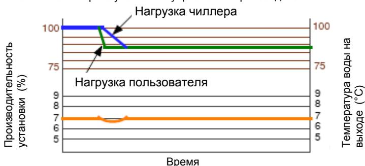
Стабильность при бесступенчатом управлении производительностью
