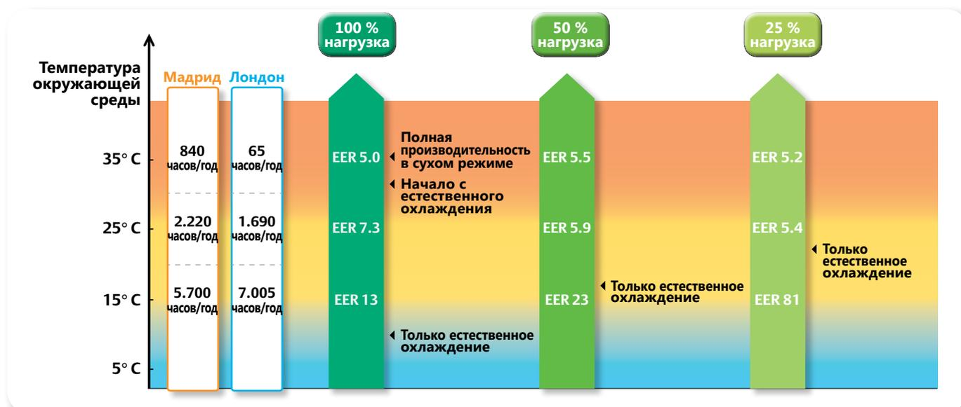
Коэффициенты эффективности для линейки FA0 при следующих условиях: адиабатическая система используется (режим испарительного охлаждения). Рассчитывается на основании средних показателей влажности, полученных из Центральной Европы.
