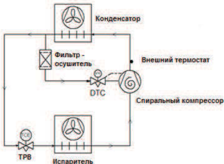
Рис. 4: Впрыск жидкости с помощью вентиля DTC
