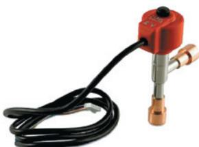
Электронный расширительный клапан, устанавливаемый в прецизионных кондиционерах LESSAR, позволяет точно дозировать подачу хладагента в испаритель, что приводит к стабильному и точному поддержанию температуры охлажденного воздуха, а также к сбережению электроэнергии.
