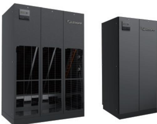
**LSP-CWK** – прецизионные кондиционеры холодопроизводительностью от 12-89 кВт, работающих по схеме с водоохлаждаемым теплообменником от источника с холодной водой. Теплообменник изготовлен из медных труб оребренных алюминиевыми lamелями. Воздушный фильтр класса очистки EU4.
