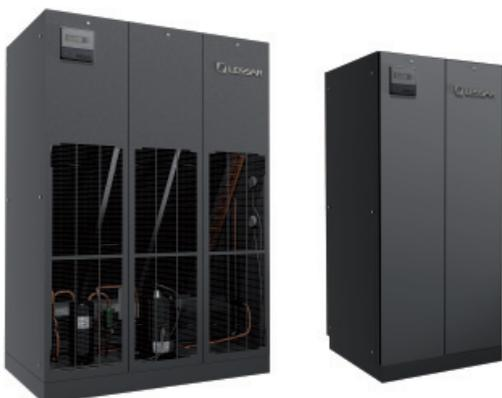
**LSP-BXK** – тип прецизионных кондиционеров холодопроизводительностью от 7-60 кВт, работающих по схеме с выносным воздухоохлаждаемым конденсатором. Воздушный конденсатор двух типов: с осевыми или центробежными вентиляторами предоставляется опционально. В качестве хладагента применяется озонобезопасный фреон R407C. Воздушный фильтр класса очистки EU4.
