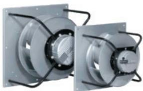
Для подачи охлажденного воздуха в помещение через нижнюю или верхнюю часть прецизионного кондиционера используются центробежные вентиляторы либо осерадиальные вентиляторы "Plug Fun" с EC-мотором. Преимуществом EC-моторов является существенное энергосбережение совместно с точным регулированием расхода воздуха в соответствии с характеристикой сети воздуховодов.
