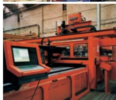
Рис. 3–10: Корпуса роторов изготавливаются на современном высокоточном оборудовании
