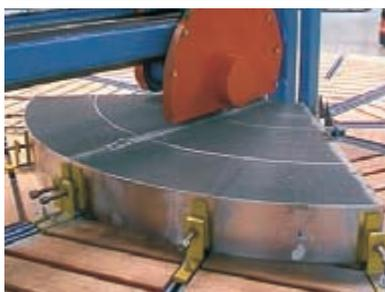
Рис. 3-3: Большие роторы делятся на несколько сегментов.
