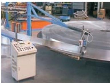
Рис. 3-1: Ротор собирается из нескольких слоев специально уложенного гофрированного алюминиевого листа.
