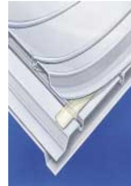
Рис. 18: Пластины скрепляются полиуретановым материалом, а затем герметизируются эпоксидной смолой
