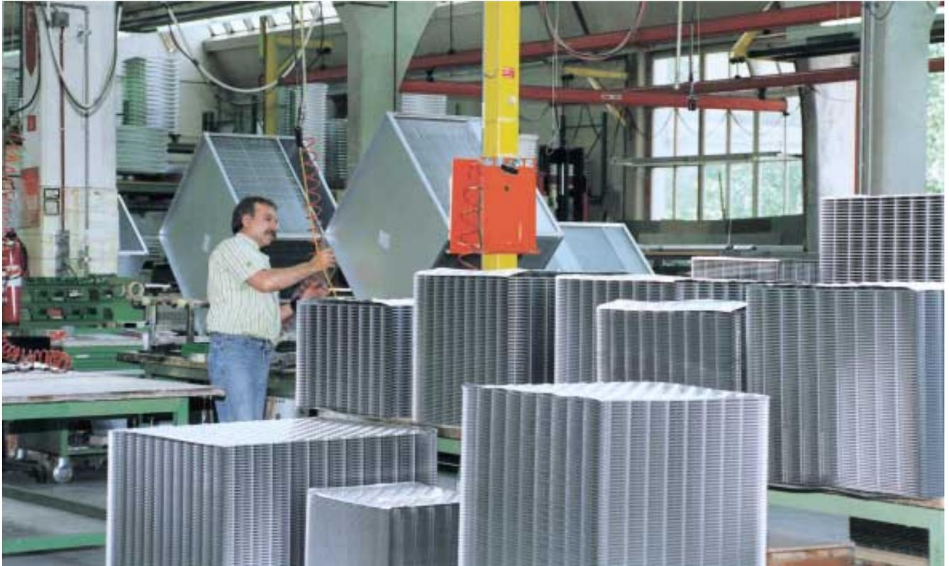
Рис. 20: Блок теплообменника плотно устанавливается внутрь корпуса.
