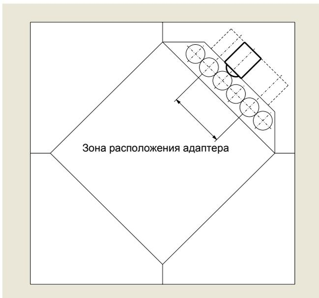
Рис. 40: Зона возможного расположения адаптера над клапаном.
