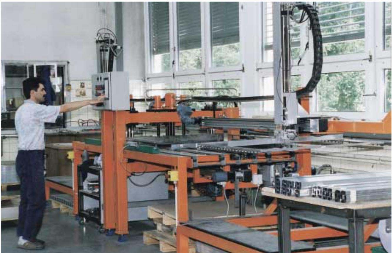
Рис. 19: Рифление пластин теплообменников типа F выполняется на специальном станке.
