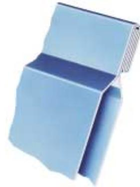
Рис. 16: Посредством двойной фальцовки достигается прочное соединение пластин
