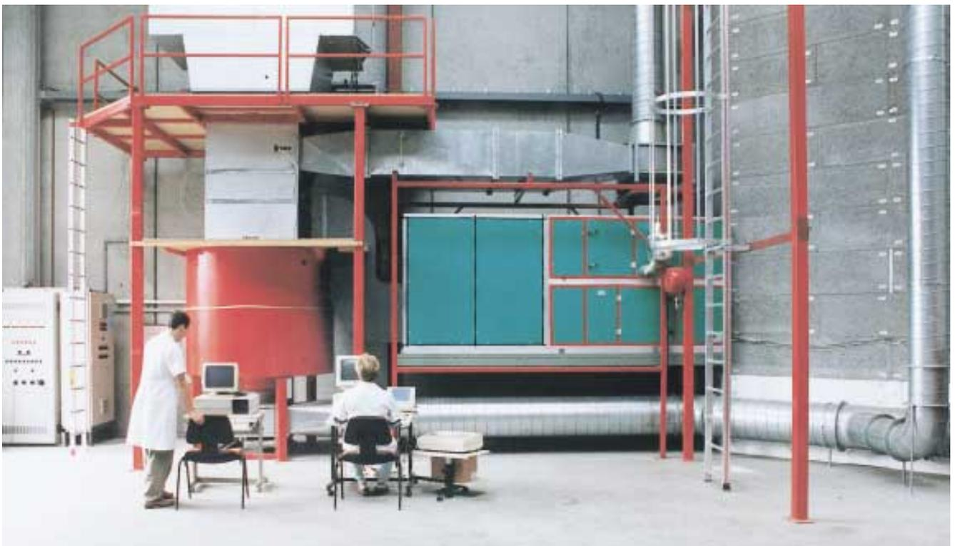
Рис. 9: Теплообменники Noval постоянно проходят стендовые испытания на соответствие техническим характеристикам
