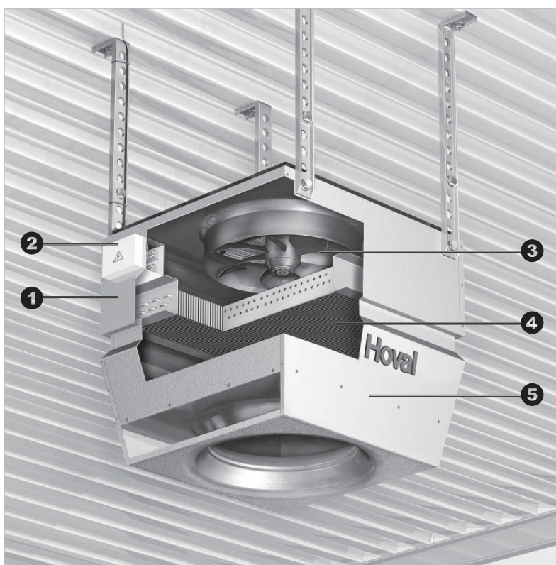
Рис. D2: Конструкция агрегата TopVent® NHV
