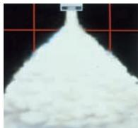
Температура приточного воздуха равна температуре воздуха в помещении. Формирование струи зависит только от **высоты установки агрегата и расхода воздуха**.
