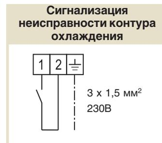
Рис. С-2: Электросхема подключения
