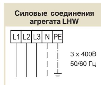
Рис. 25: Силовые соединения агрегата LHW
