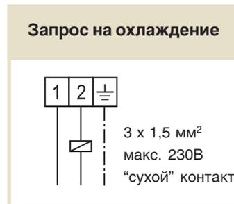
Рис. С-1: Электросхема подключения
