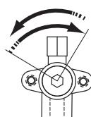
Отвинчивается против часовой стрелки
