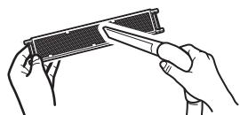
**3** Замочіть фільтр у теплій воді протягом 10~15 хвилин.
