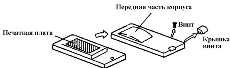
Снимите крышку, закрывающую винт, вывинтите один из винтов и снимите переднюю часть корпуса адаптера.
