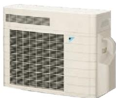
Для увлажнения, по-японски 'Ururu', влага абсорбируется из наружного воздуха. Далее, увлажненный наружный воздух подается во внутренний блок и равномерно распределяется по помещению. Поэтому система Ururu Sarara работает без водяного бака и служит для равномерного распределения увлажненного воздуха. Такой принцип полностью отличается от работы традиционных увлажнителей.
