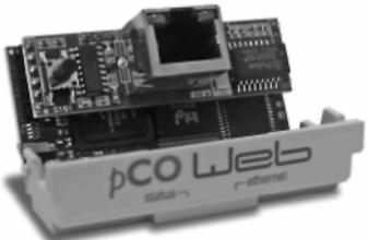
**плата последовательного интерфейса Ethernet: PCO1000WB0**
