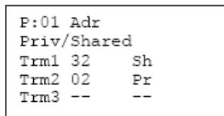
Измените настройки терминалов в соответствии с требованиями. Кнопка ENTER используется для перемещения курсора из одного поля в другое, а кнопки UP и DOWN - для изменения значения текущего поля. Р:xx показывает адрес выбранной платы рСО (в показанном на рисунке примере это плата 1).
