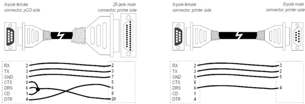
Характеристики и настройки порта последовательного принтера на карте для графического дисплея
