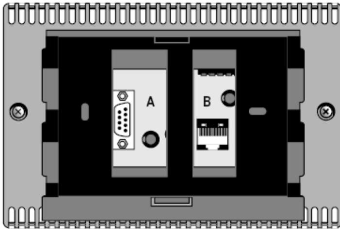
Эти терминалы уже снабжены 9-штырьковыми коннекторами для соединения с принтером через последовательный принтерный кабель, 9-штырьковый (pCOxs)-25-штырьковый (принтер)
