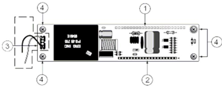
Внимание: в соответствии с расположением коннектора 3 на ни при каких условиях не прикасайтесь к плате руками или токопроводящими предметами (высокое напряжение 360Vac)
