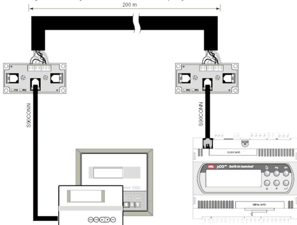
Рисунок 5.5.2.2 пердстеляет шунт *TCONN6J000*, используемый в паре для удаленной установки pCOxs в сети pLAN с экранированным кабелем AWG24
