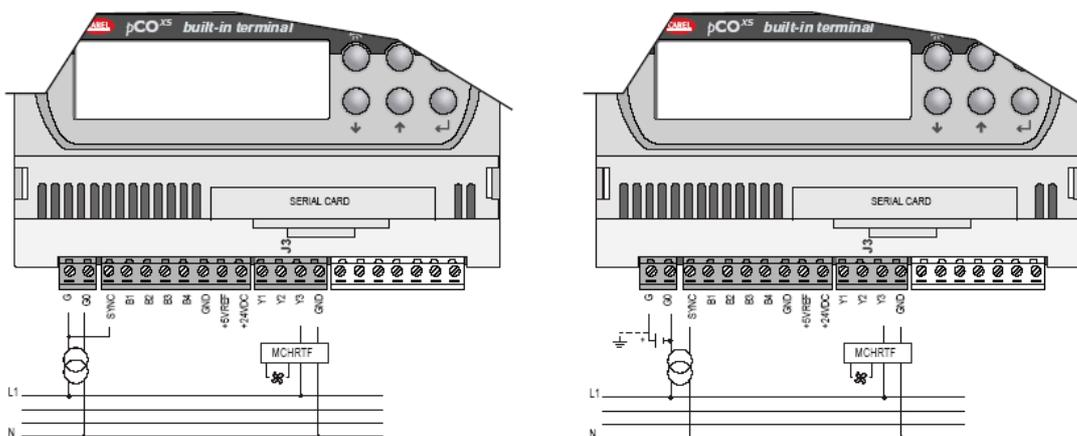
Замечание: источник питания на 24 V<sub>ac</sub> должен иметь ту же фазу, что и питание привода. Таблица 4.7.1 суммирует распределение аналоговых выходов в соответствии с версией.
