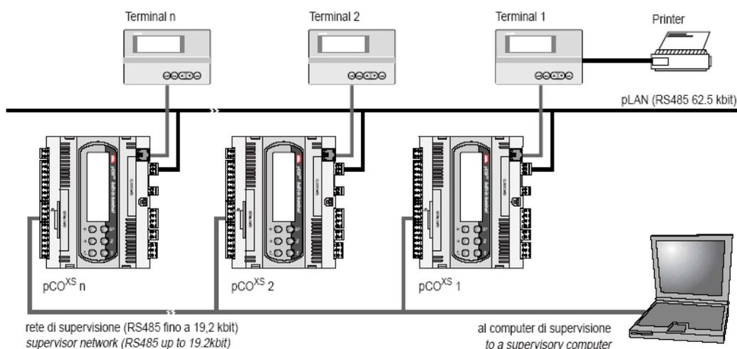
Программы для различных приложений (стандартный чиллер, стандартный кондиционер и пр.) не могут быть автоматически интегрированы в сеть pLAN. Они должны быть изменены в соответствии со структурой сети и перекомпилированы программой EasyTools.
