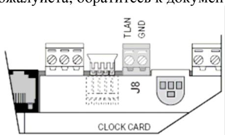
Приведем пример 3х жильного соединения с 24 Vdc питанием, включая и шину, и питание индивидуальных приводов.
