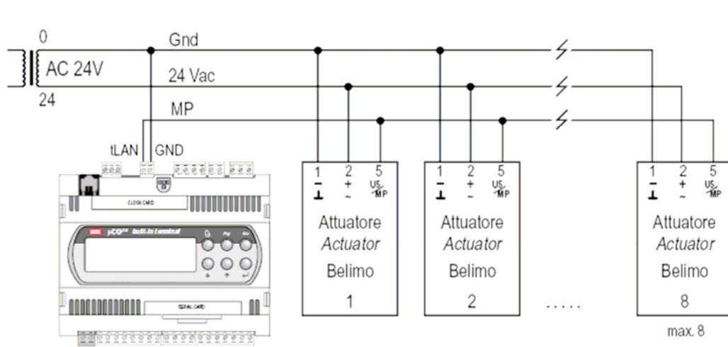
Каждый привод belimo может также быть соединен с активным или пассивным датчиком температуры, или цифровым контактом. Эти датчики должны быть подключены к терминалу 3 привода, и соединение может меняться в зависимости от используемого типа датчика. Чтение выполняется сервоприводом и передается в цифровом виде контроллеру по шине.
