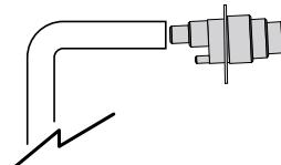
SDP\*: пластмассовая форсунка производительностью до 18 кг/ч
