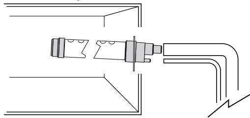
DP\*: линейный парораспределитель (диаметр входного отверстия 22, 30 и 40 мм)
