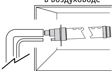
DP\*: канальный парораспределитель (вх. Ø 22, 30, 40 мм)
