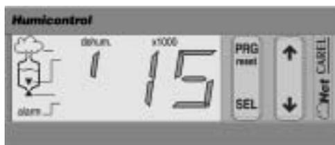
**Предупреждение:** цифровые значения от 200 до 255 отображаются знаком «/» вместо цифры сотен 2 ( из-за конструктивных особенностей экрана). На Рис. 7.1 показан пример отображения числа «215».
