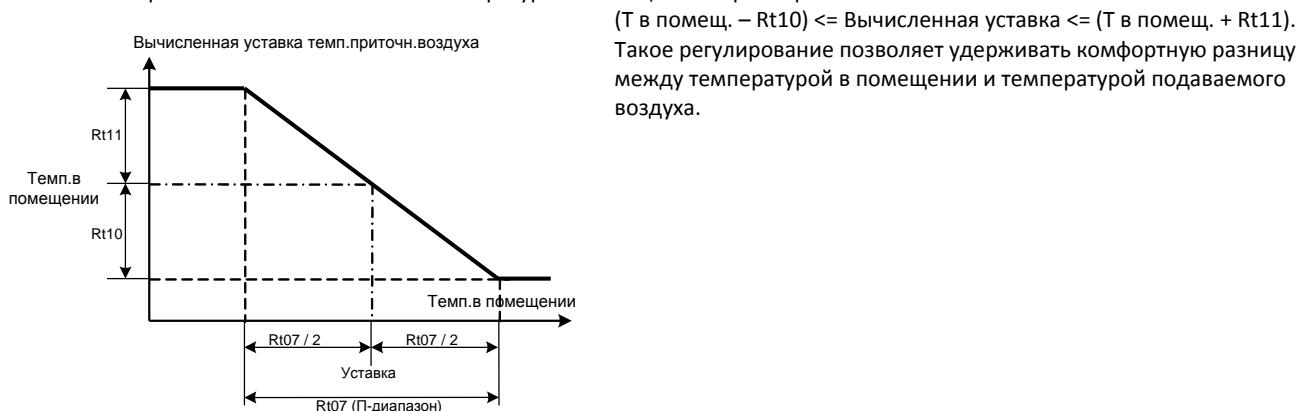
2. **Rt09=1.** Уставка температуры изменяется относительно каскадной уставки в зоне, ограниченной абсолютными значениями, задаваемыми с помощью параметров Rt10 и Rt11.
