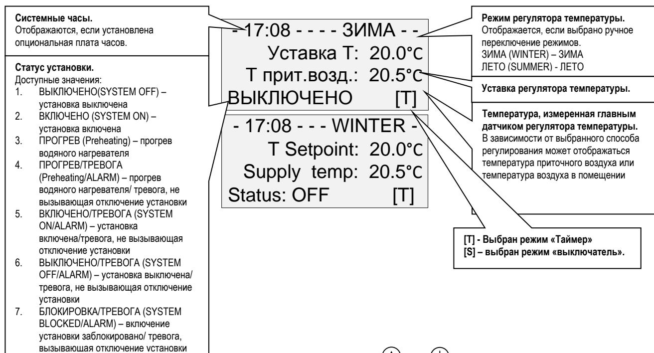
Если производится регулирование влажности, то при нажатии на кнопку или произойдет переход на вторую страницу состояния, содержащую информацию об уставке относительной влажности и значение относительной влажности, измеренное главным датчиком.
