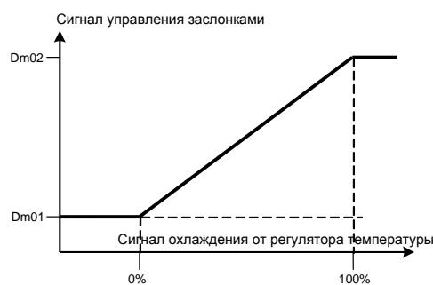
Если сконфигурировано фиксированное положение заслонок, то после получения разрешения на открытие заслонки устанавливаются в положение, заданное соответствующим параметром.
