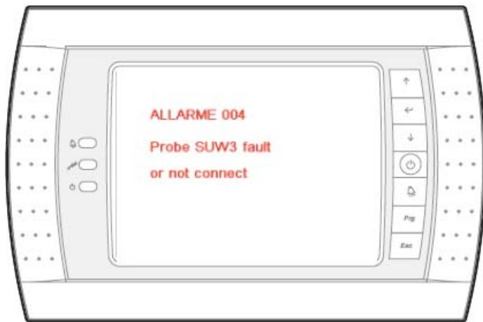
Показания датчика SUW3 выходят за пределы  $-35^{\circ}/80^{\circ}\text{C}$  или датчик не подключен (независимо от того, какая из плат - PCO1 или PCOE - используется).
