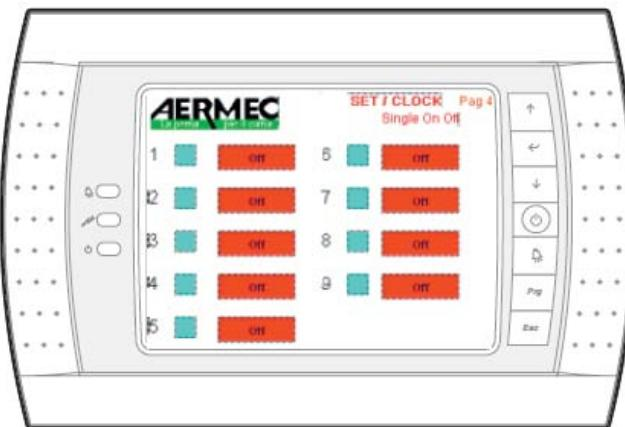
Эта экранная страница служит для включения/выключения отдельных холодильных машин. Слева от кнопок включения/выключения (On/Off) расположены пиктограммы, соответствующие каждой холодильной машине, охваченной системой управления. При нажатии кнопки соответствующая холодильная машина включается/выключается. Программа управления контролирует соответствие выключенных холодильных машин заданному порядку чередования включений/выключений.
