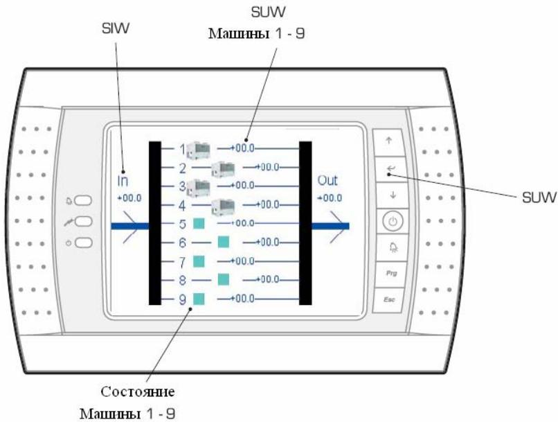
На экране первичный контур изображен синим цветом, вторичный – красным, а элементы гидравлического контура – черным.
