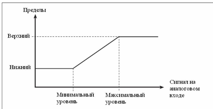
Эта функция активируется в соответствии с состоянием цифрового входа ID4: при замкнутом контакте многофункциональные аналоговые входы активны.
