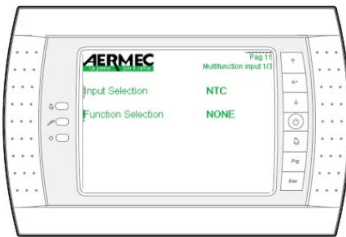
Имеется три аналоговых входа, с помощью которых можно производить операции четырех типов. Вход B1 рассчитан на токовый сигнал 0 – 20 мА, на вход B2 подается напряжение 0 – 5 В, вход B3 используется для подключения датчика NTC с сопротивлением 10 кОм. Тип входа задается параметром Input Selection, а назначение входа – параметром Function Selection:
