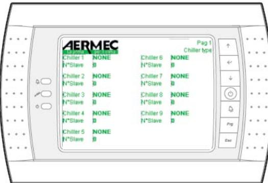
Определение наличия и типа холодильных машин 1 – 9 (не более 9).
