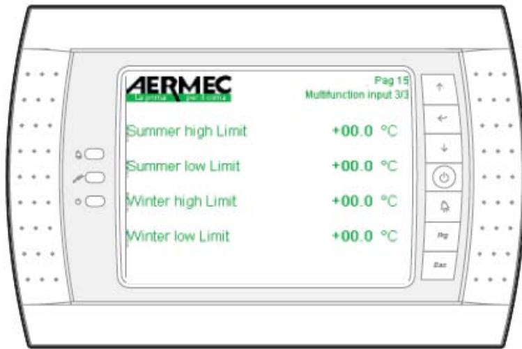
Использование многофункционального входа для задания установочного значения температуры.
