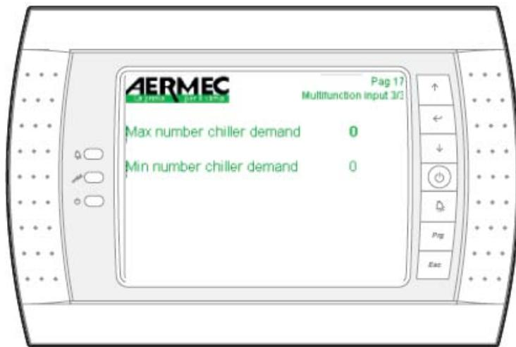
Использование многофункционального входа для запроса числа работающих холодильных машин.
