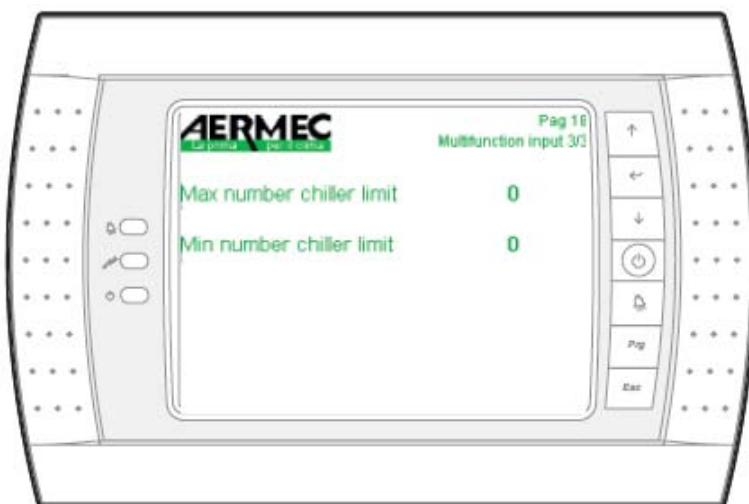
Использование многофункционального входа для ограничения числа работающих холодильных машин.
