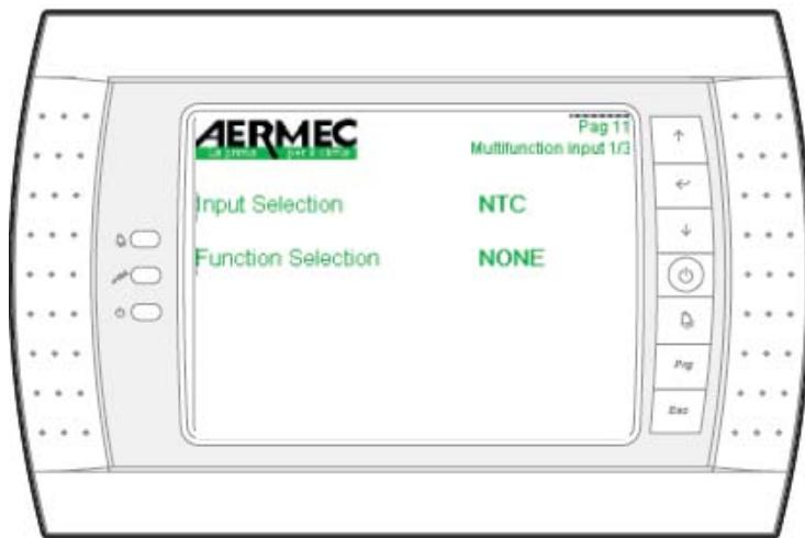
Выбор типа многофункционального аналогового входа: NTC, 0 – 20 мА, 0 – 5 В (NTC – датчик температуры с сопротивлением 10 кОм).
