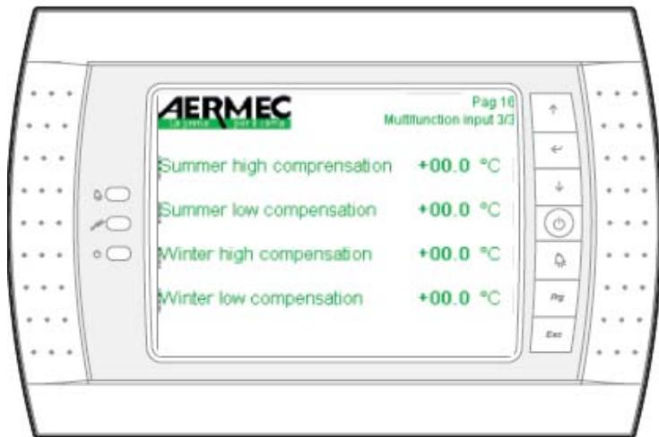
Использование многофункционального входа для задания компенсационного значения температуры.
