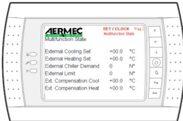
**External Cooling Set:** установочное значение температуры в режиме охлаждения, заданное по сигналу на аналоговом входе, если соответствующая функция активирована.
