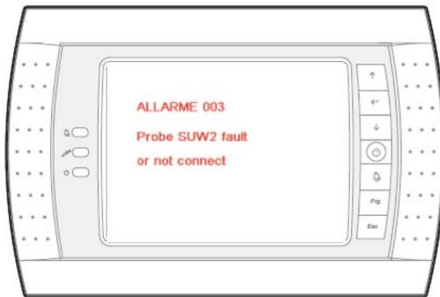
Показания датчика SUW2 выходят за пределы  $-35^{\circ}/80^{\circ}\text{C}$  или датчик не подключен (независимо от того, какая из плат - PCO1 или PCOE - используется).
