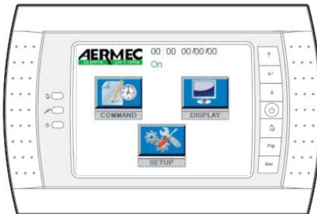
**Виртуальная кнопка COMMAND** служит для перехода к меню пользователя (если это возможно с данного терминала). В этом меню можно осуществить все функции управления холодильными машинами (задать установочные значения температуры, запрограммировать временные параметры, осуществить сброс аварийной сигнализации, включить или выключить отдельные холодильные машины и т.п.).
