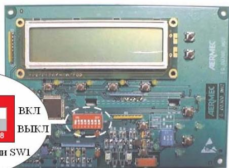
Отключение всех программных таймеров: цифровые входы дистанционного управления в положении On и Hot
