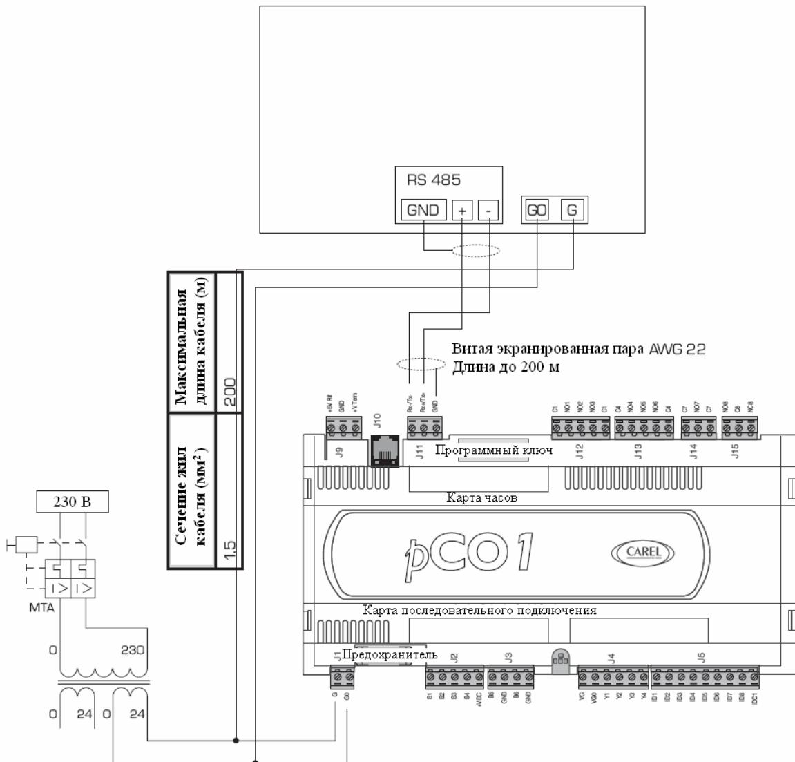
При подключении питания платы рCO1 и дисплея необходимо соподать полярность: контакты G и G0 платы соединяются с контактами G и G0 дисплея.
