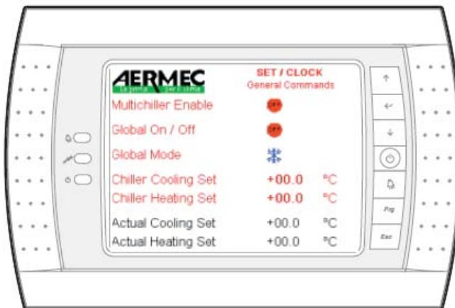
**Multichiller Enable:** активизация включения/отключения холодильных машин по команде системы управления. В положении OFF все холодильные машины постоянно включены независимо от зарегистрированной температуры. Контроль времени, функции глобального включения/отключения и отключения отдельных холодильных машин постоянно активированы. При выборе опции OFF Multichiller служит для контроля параметров работы холодильных машин.
