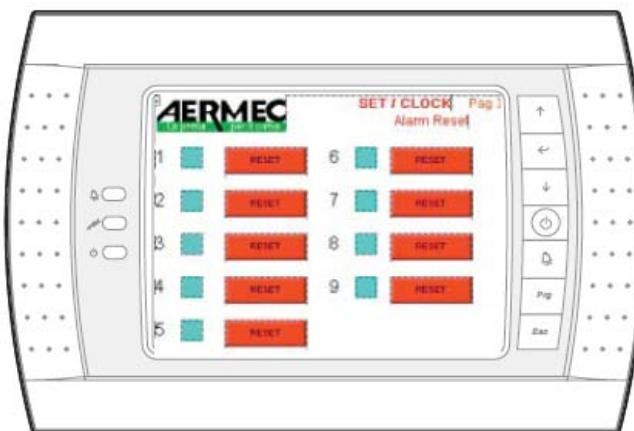
Эта экранная страница служит для сброса аварийной сигнализации отдельных холодильных машин. Слева от кнопок возврата в исходное положение (RESET) расположены пиктограммы, соответствующие каждой холодильной машине, охваченной системой управления. При нажатии кнопки RESET на соответствующую холодильную машину поступает сигнал сброса аварийной сигнализации. Прочес возврата в исходное состояние занимает несколько секунд.
