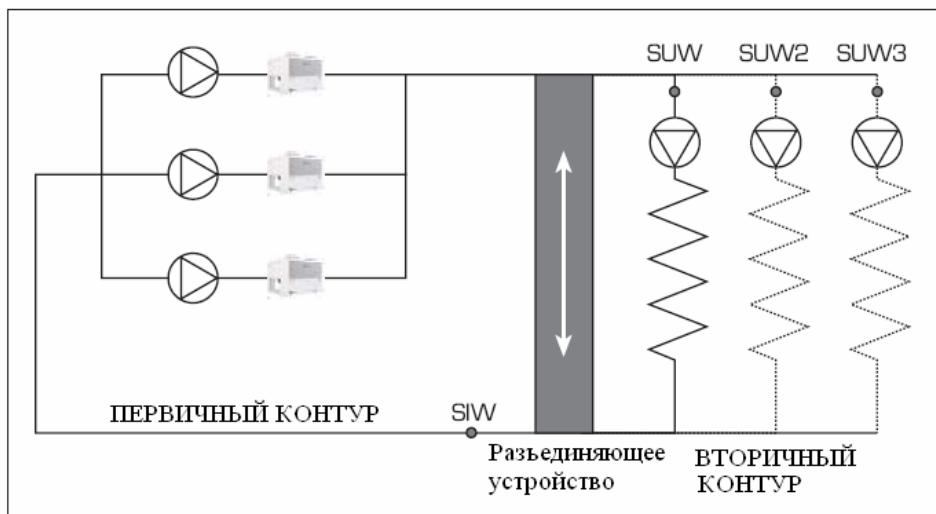
При таком способе управления контролируется температура воды, поступающей во вторичный контур. Имеется возможность контроля температуры в нескольких (до трех) ответвлениях вторичного контура с помощью датчиков SUW, SUW2 и SUW3 (последний датчик можно использовать только при наличии карты расширения рСОЕ). Показания
