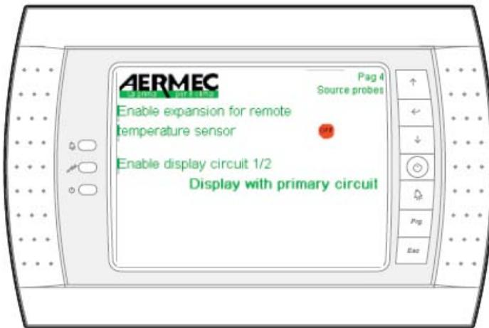
**On:** активизация карты расширения рСОЕ с датчиками SIW и SUW, подключенными к ней. Выбор типа синоптической информации, выводимой на дисплей в информационном меню. Эта информация может относиться только к первичному контуру или к обоим первичному и вторичному контурам.
