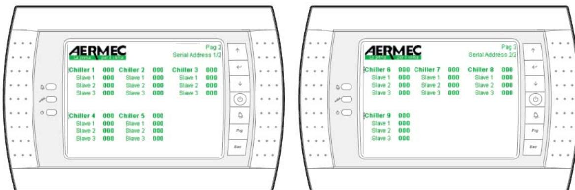
Задание последовательных адресов холодильных машин. Для холодильных машин серий RV, NW, RVB, NSB, WSB можно также задать адреса сетевых плат, относящихся к компрессорам подчиненных машин, если имеется интерфейс AER485P2. Адреса принимают значения от 1 до 255, причем их порядок не обязательно должен соответствовать физическому расположению холодильных машин.
