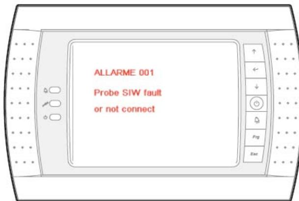
Показания датчика SIW выходят за пределы  $-35^{\circ}/80^{\circ}\text{C}$  или датчик не подключен (независимо от того, какая из плат - PCO1 или PCOE - используется).
