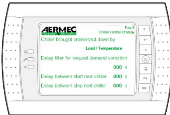
Независимо от типа управления (Load или Temperature) вводятся задержки («временные фильтры») на включение/выключение холодильных машин. Это необходимо для предотвращения внезапных скачков температуры, для подготовки запуска и отключения компрессоров, а также для того, чтобы после включения холодильная машина успела выйти на нужный уровень производительности.
