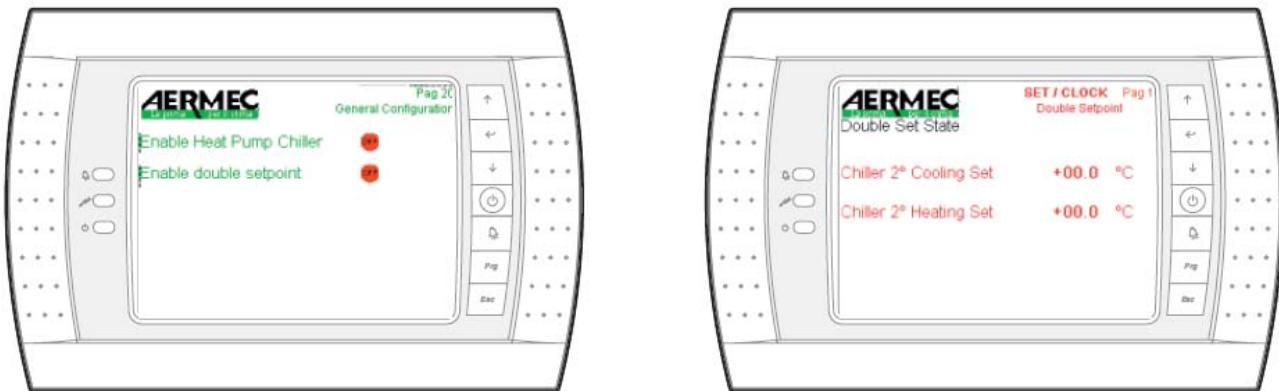
Эта функция активируется по команде Enable double setpoint с помощью контакта цифрового входа ID3. При этом становится возможным использование альтернативного установочного значения температуры (например – для ночного периода):
