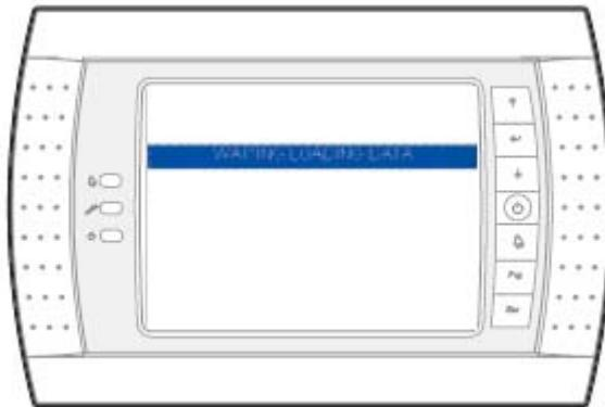
Нажав кнопку рядом с изображением холодильной машины, можно получить доступ к детальной информации о ней. Такое изображение на экране появляется лишь на несколько секунд, пока длится загрузка данных о данной холодильной машине. Если холодильная машина отсутствует (что индицируется синим квадратиком), такое изображение может оставаться на экране сколь угодно долго.
