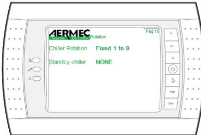
Чередование работы холодильных машин 1 – 9 в зависимости от времени наработки компрессоров.
