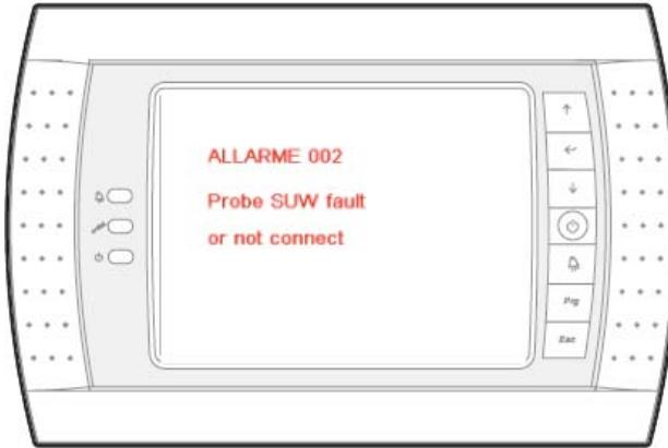
Показания датчика SUW выходят за пределы  $-35^{\circ}/80^{\circ}\text{C}$  или датчик не подключен (независимо от того, какая из плат - PCO1 или PCOE - используется).
