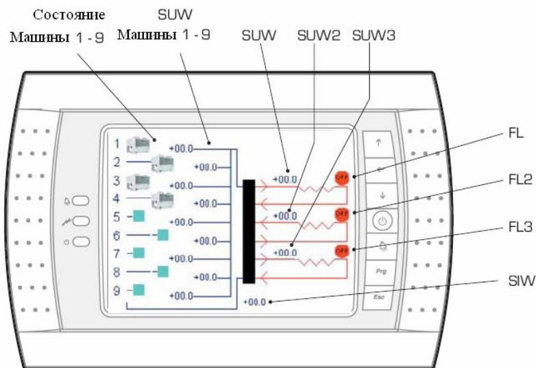
На этой экранной странице в наглядной форме показано состояние холодильных машин, входящих в систему. Имеется два типа синоптической информации о работе системы, которые выбираются в настоечном меню (экранная страница 4). Можно получить информацию о контурах 1 или 2.
