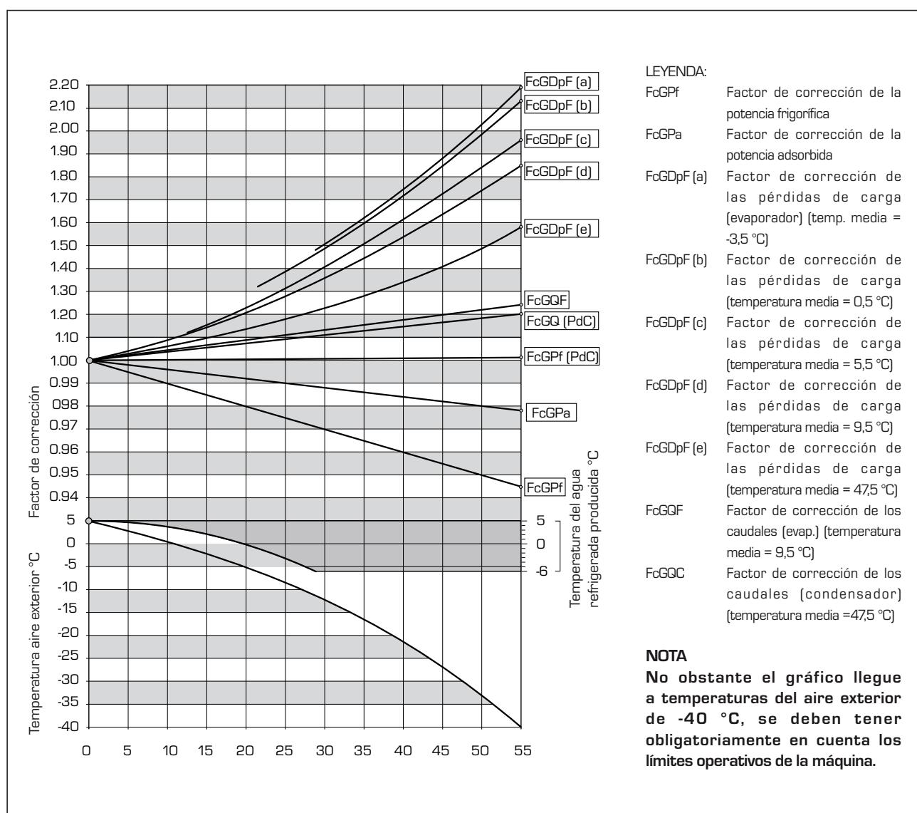
temperatura del agua producida, se tendrá que entrar por el eje derecho y una vez intersecada la curva se procederá a trazar una línea vertical, la cual a su vez intercecerá las demás curvas; Los puntos obtenidos de las curvas superiores representan los coeficientes para la potencia de refrigeración y absorbida, para
