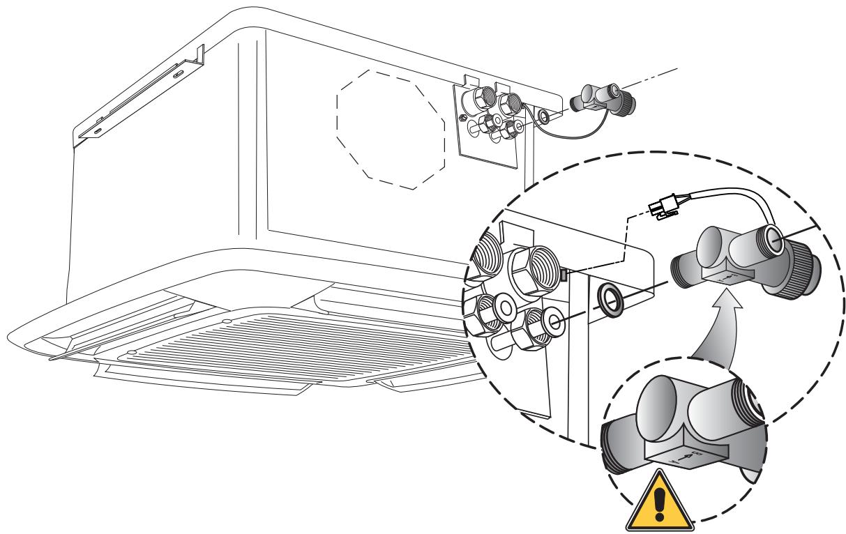
**D** Der Bausatz besteht aus einem Ventil, einem Steller und eine Dichtung.
