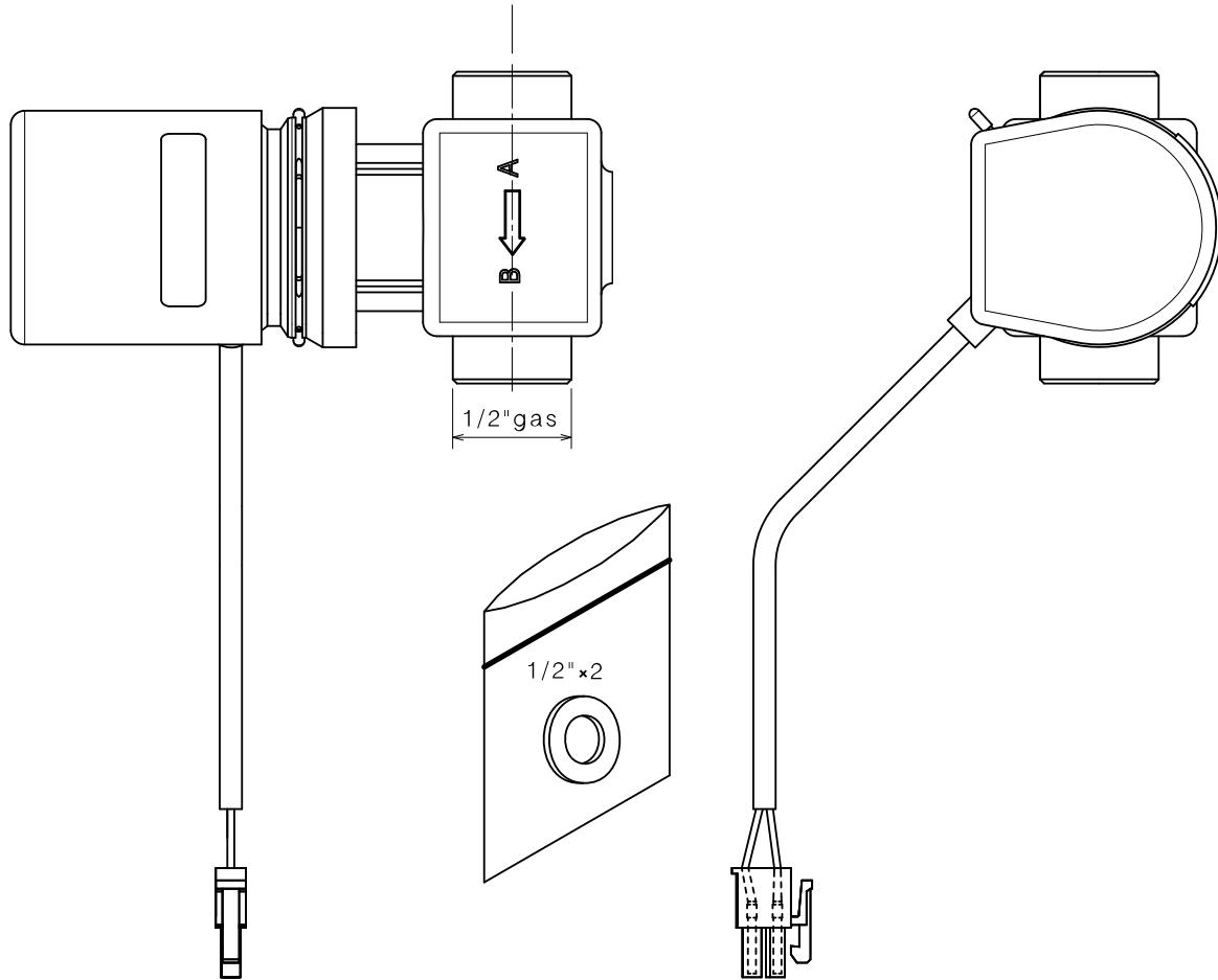
El kit está constituido por una válvula, por el relativo accionador y por una guarnición.
