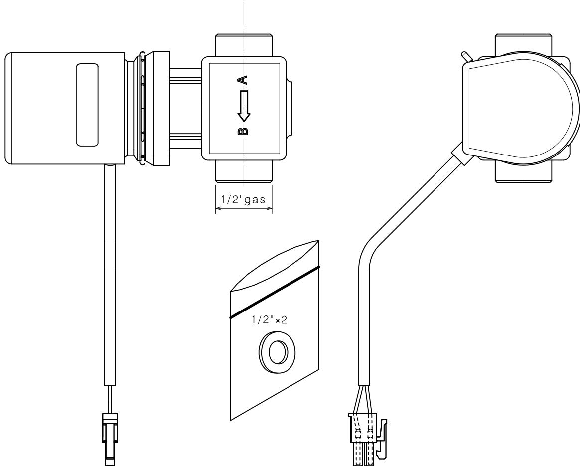
**F** Le kit est composé d'une vanne, de son actionneur et de un joint.
