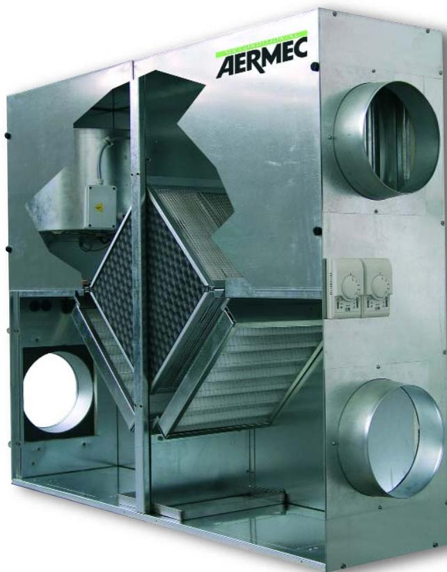
Доводчики такого типа позволяют удалить часть отработанного воздуха из помещения и заменить его таким же количеством свежего воздуха. Пластинчатый теплообменник из алюминия с встречным потоком обеспечивает эффективный теплообмен между отработанным и свежим воздухом, что, в зависимости от сезона, приводит к предварительному нагреву или охлаждению свежего воздуха. Прежде, чем попасть в рекуперационный теплообменник,
