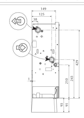
Attacchi batteria (femmina) • Coil connections (female) • Raccords de batterie (femelle) • Anschlüsse Wärmetauscher (Innengewinde) • Conexiones batería (hembra)
