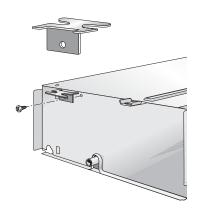
La parete di supporto deve essere perfettamente piana, per il fissaggio usare 4 tasselli ad espansione con caratteristiche adeguate al tipo di parete (non forniti).
