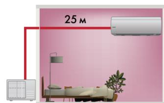
Чем больше допустимая длина труб, соединяющих блоки (фреоновой трассы) – тем удобнее выбрать место для блоков и монтировать систему. У мультисплит-систем Toshiba длина трассы может достигать 80 метров, а расстояние от наружного до внутреннего блока – до 25 метров. Допустимый перепад высот между наружным и внутренними блоками до 15 м, а значит можно кондиционировать даже трехэтажный дом одной системой!
