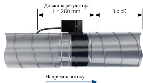
Мал.4: Рекомендована відстань перед регулятором RDR-2 при роботі з припливним повітряним потоком
