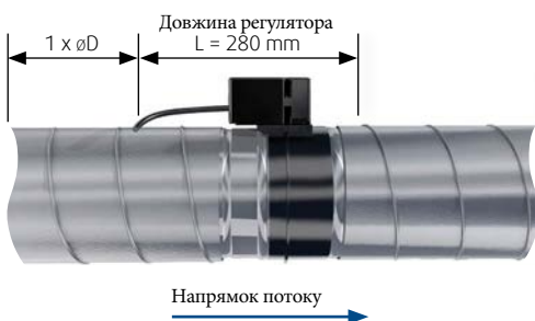
Мал.1: Рекомендована відстань перед регулятором RDR-2 при роботі з витяжним повітряним потоком
