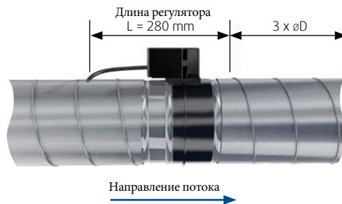
Рис.4: Рекомендуемое расстояние перед регулятором RDR-2 при работе с приточным воздушным потоком
