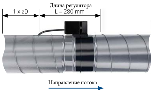
Рис.1: Рекомендуемое расстояние перед регулятором RDR-2 при работе с вытяжным воздушным потоком
