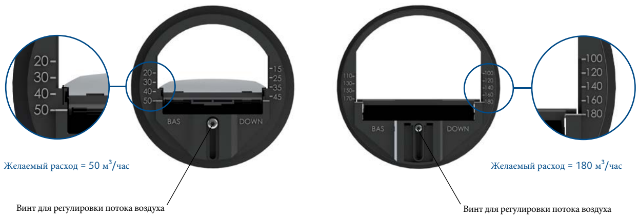
Рис. 5: Настройка расхода воздуха для RDR-2.
